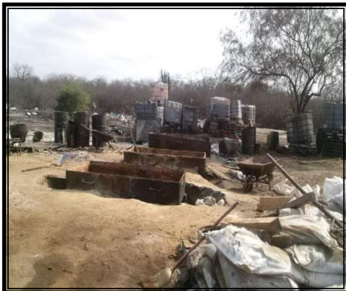
Foto 11. Cocina en tanques rectangulares de hierro naval con leña. Foto 12. Seca en pista y en pampa (al sol).
